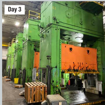
2200 Erfurt (Schuler) 5 Press Tandem Press Line 169" Bed Area
