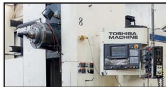
TOSHIBA BTD-13FR22 SPINDLE AND TOSNUC CONTROL
