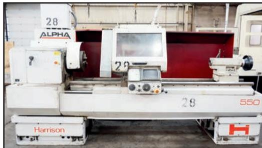
HARRISON ALPHA-500 CNC GAP BED LATHE
