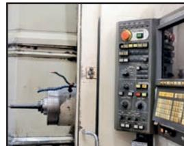
TOSHIBA BMC-100E CNC VIEW OF SPINDLE AND CONTROL
