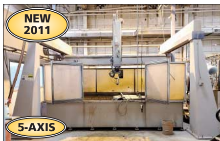
8' X 12' PAR Systems Waterjet Cutting Machine
