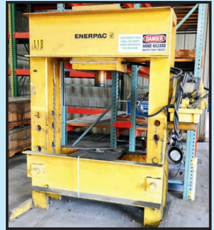
ENERPAC 200 T. H-FRAME HYDRAULIC PRESS
