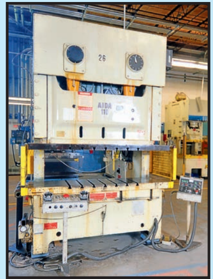
AIDA 121 T. DOUBLE CRANK GAP PRESS
