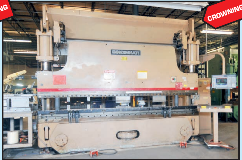
CINCINNATI 230 T. X 12' CNC PRESSBRAKE
