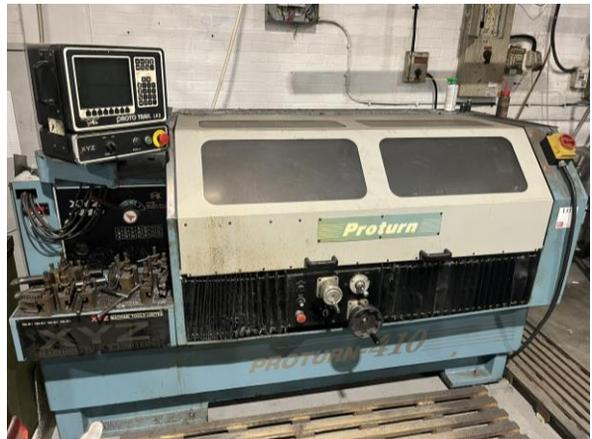
XYZ Proturm 410 CNC Lathe
