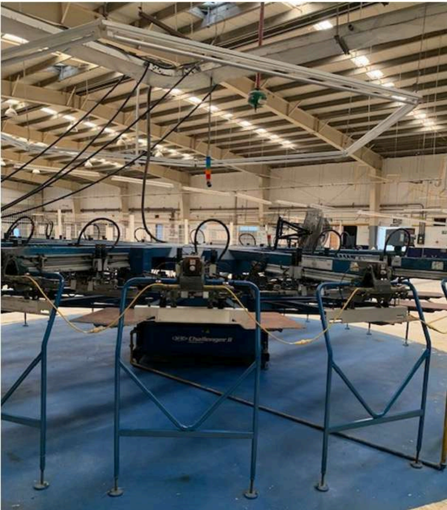
1 Impresora Challenger II de 16-18 estaciones M&R 2007 Challenger II 16 color
